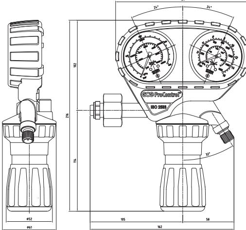
La protection arrière en caoutchouc évite l'infiltration de la poussière et d'autres impuretés.
