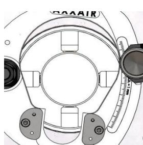
Serrage concentrique **4 mors inox en standard**, ne déforme pas les tubes
