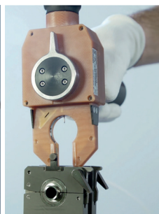
Cassette de bridage amovible, idéale pour les tubes à souder en position sur chantier ou pour la fabrication de modules préassemblés en atelier.
